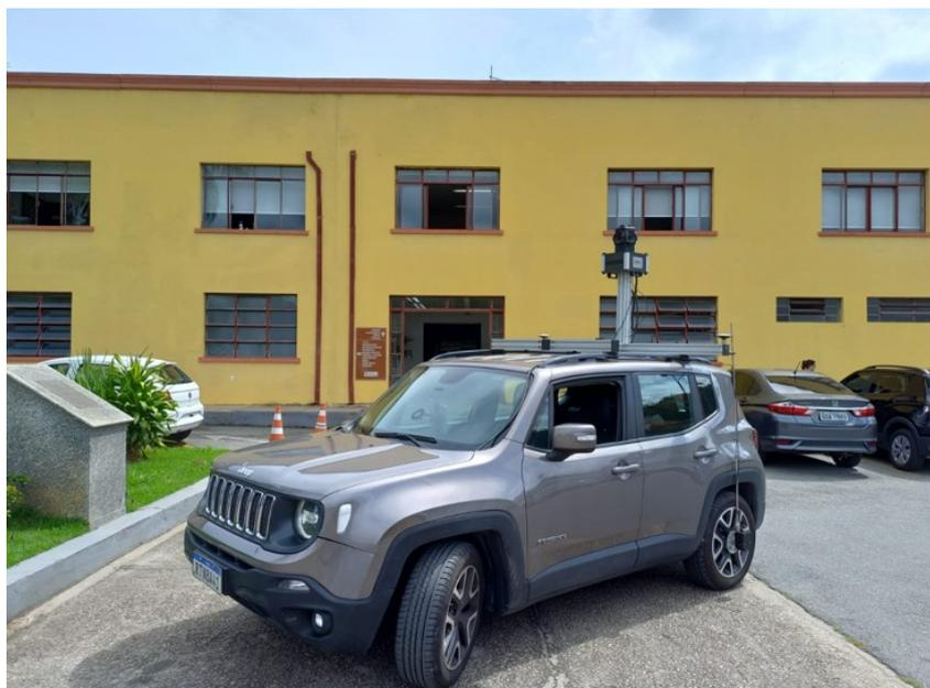
Figura 3: Veículo do Mapeamento Móvel Terrestre 360°.
