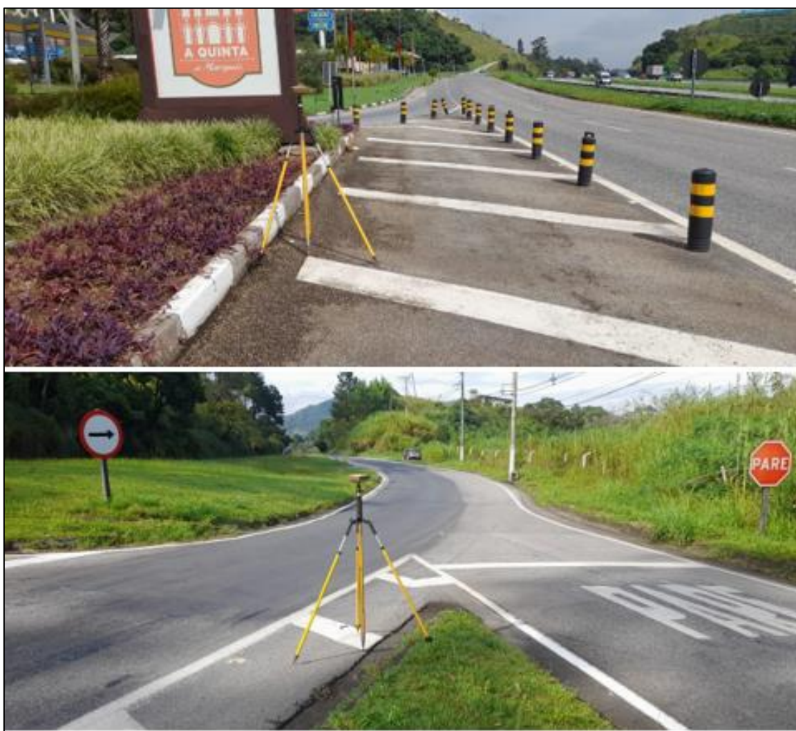
Figura 55 Implantação dos Pontos de Apoio
