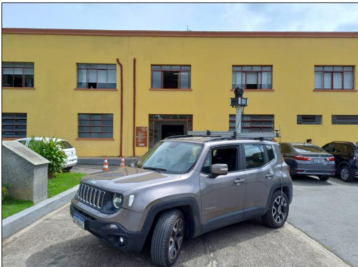
Figura 77 Veículo do mapeamento móvel terrestre
