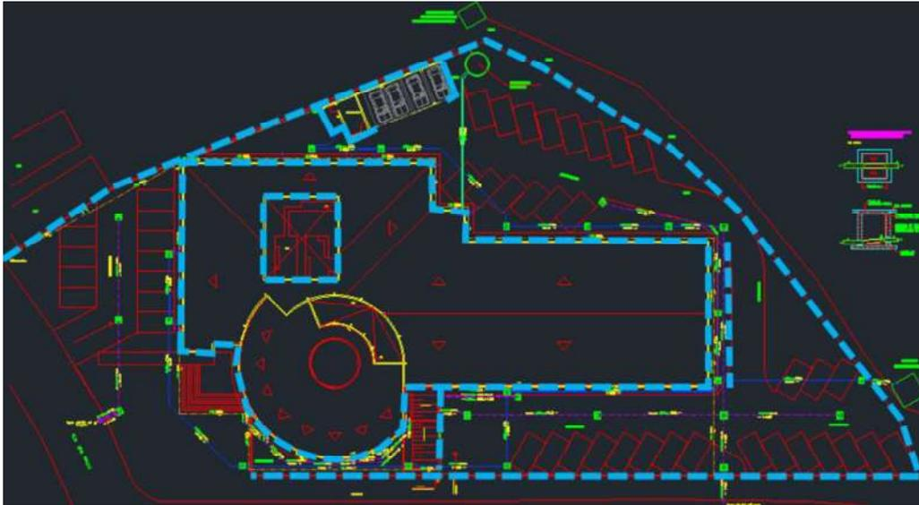
Imagem 22 – As retas e curvas tracejadas em Azul claro indicam as áreas que necessitam de impermeabilização em seu entorno, perfazendo um total de 505 m/L (considerar altura média 1 metro de impermeabilização) – 505m<sup>2</sup>. – Considerar também Pingadeiras nos muros: 171 m
