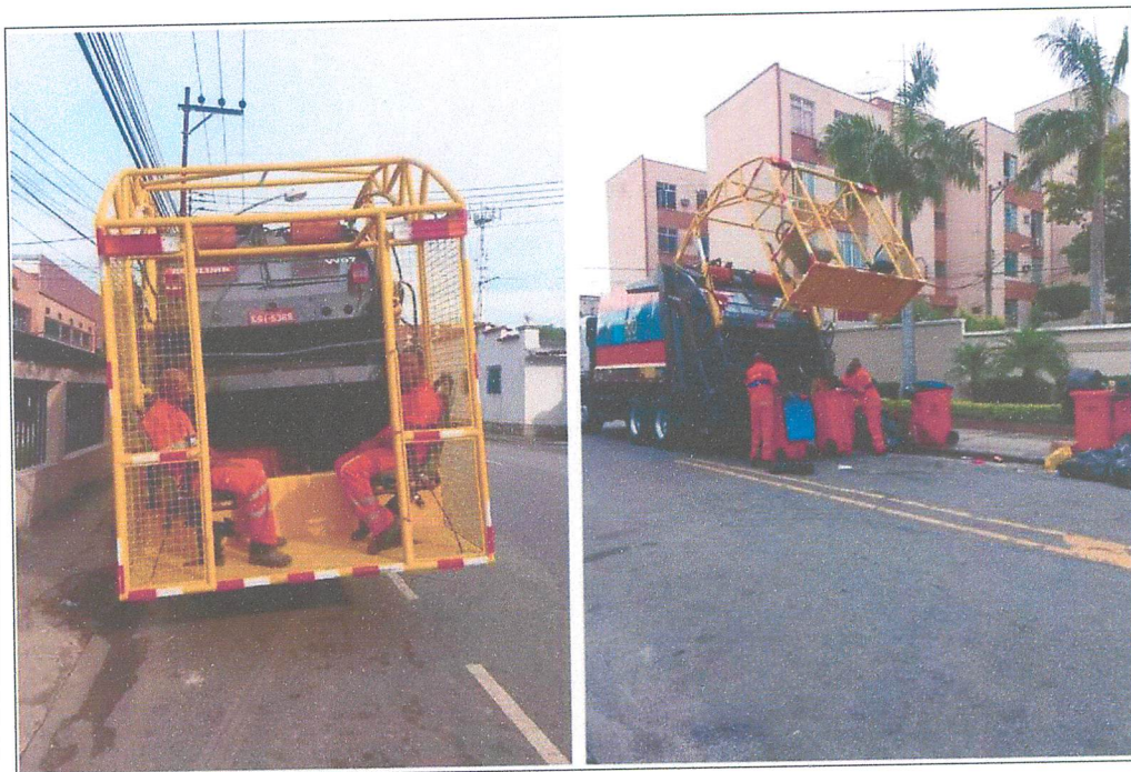
Imagem: Célula de segurança instalada em caminhão coletor de lixo.
