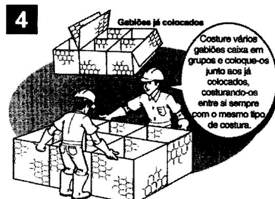
Figura 4. Posicionamento dos gabiões antes de seu enchimento.
