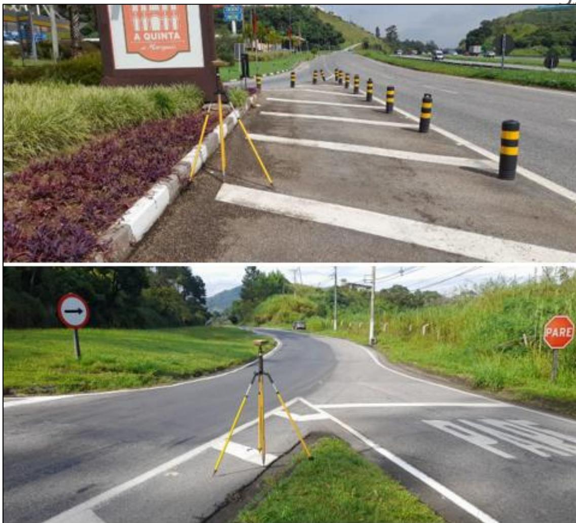
Figura 78. Implantação dos Pontos de Apoio
