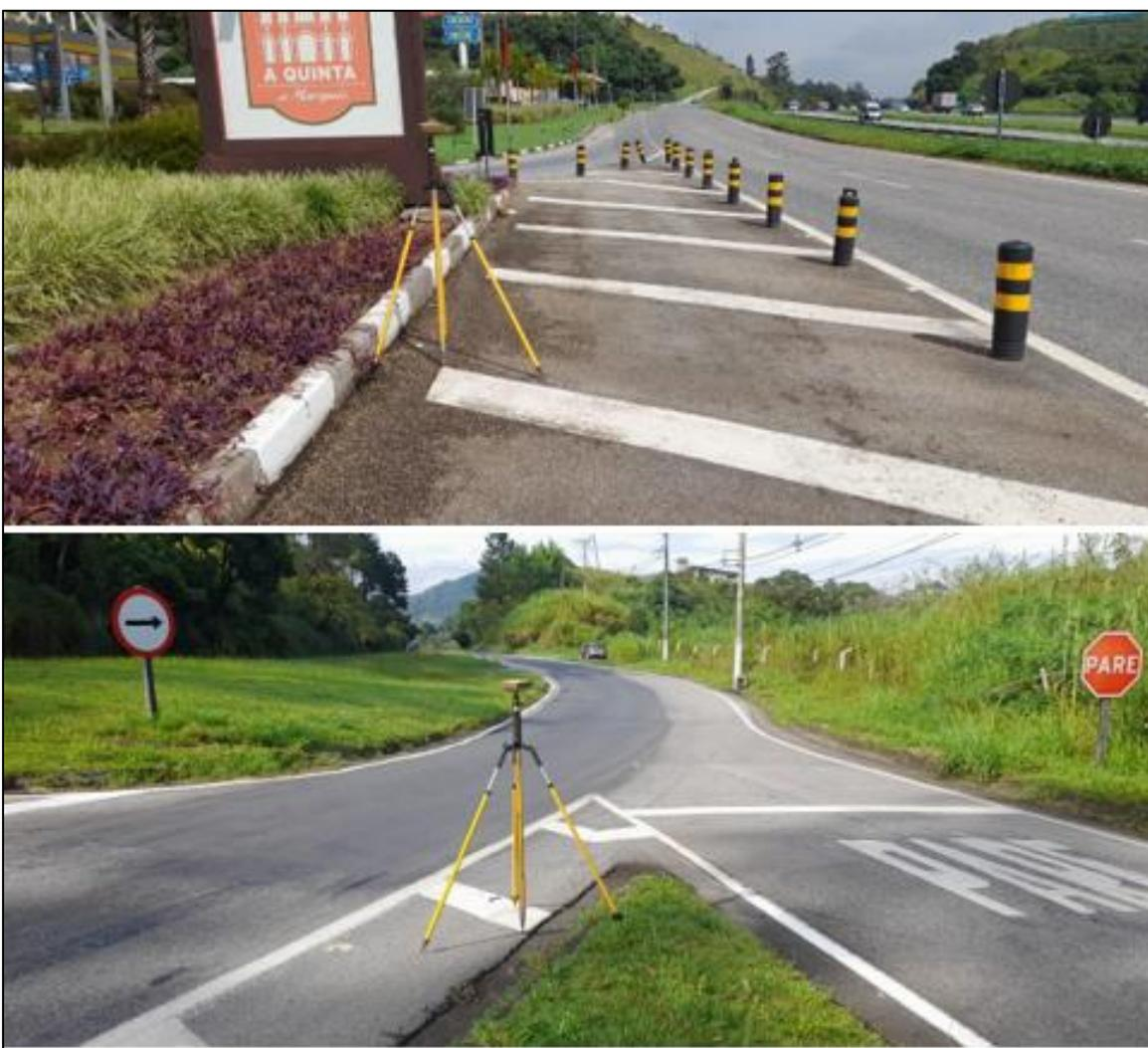
Figura 55 Implantação dos Pontos de Apoio
