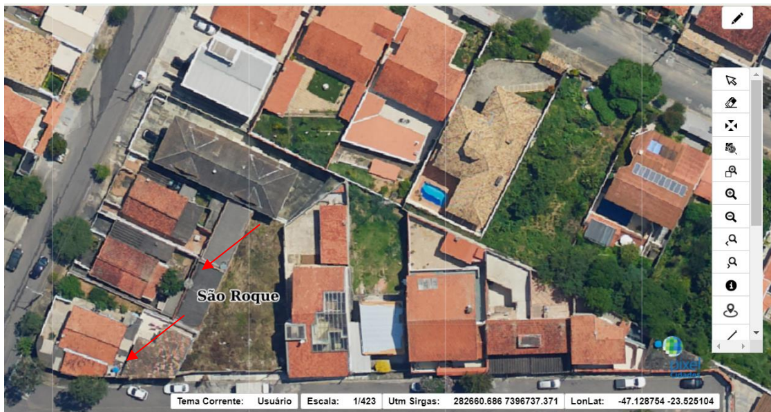
Figura 49 Alvos identificáveis em imagem aérea com GSD de 10 cm
