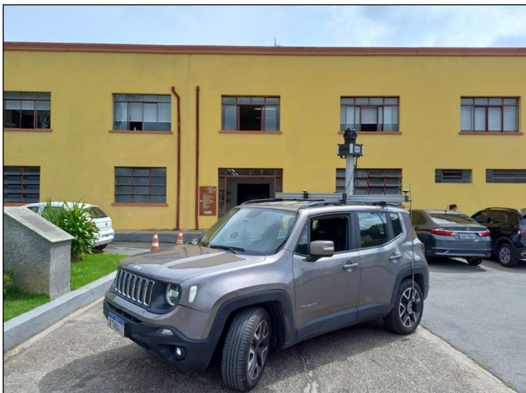
Figura 57 Veículo do mapeamento móvel terrestre
