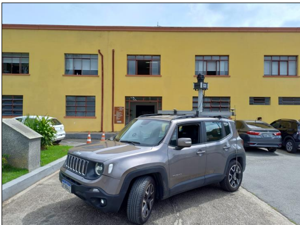
Figura 36 Veículo do mapeamento móvel terrestre
