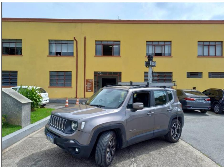
Figura 23. Veículo do mapeamento móvel terrestre
