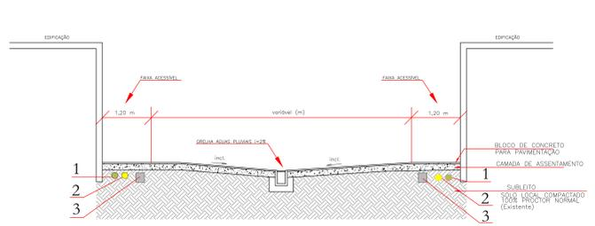
CORTE ESQUEMÁTICO ESC. 1:50
